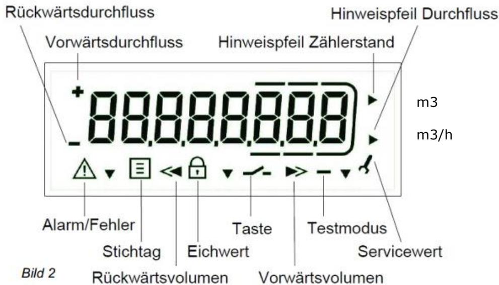
Um die Batterie zu schonen, fällt die Anzeige nach vier Minuten Ruhezustand in den Schlafmodus (Anzeige aus). Mit einem Tastendruck wird die Anzeige wieder aktiviert. Bleibt das Display dunkel muss mit Taschenlampe zusätzliches Licht darauf gegeben werden.
